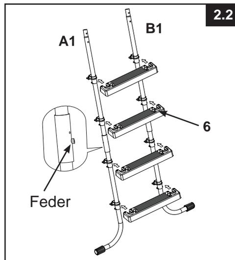
**WICHTIG:** Versichern Sie sich, dass alle Stangen sicher und fest zusammengebaut sind. Kontrollieren Sie ob die Splints eingerastet sind bevor Sie mit der Befestigung einer weiteren Stufe fortfahren. Versichern Sie sich, dass die J-förmigen FüÙe nach auÙen schauen bevor Sie die Stufen montieren.
