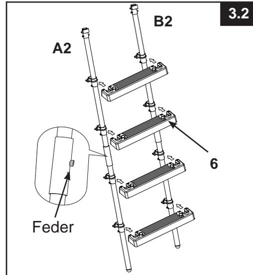
**WICHTIG:** Versichern Sie sich, dass alle Stangen sicher und fest zusammgebaut sind. Kontrollieren Sie ob die Splints eingerastet sind bevor Sie mit der Befestigung einer weiteren Stufe fortfahren.
