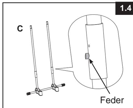
**WICHTIG:** Versichern Sie sich, dass alle Stangen sicher und fest zusammgebaut sind. Kontrollieren Sie ob die Splints eingerastet sind bevor Sie mit der Befestigung einer weiteren Stufe fortfahren.
