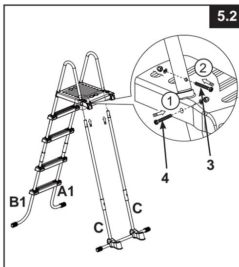
**WICHTIG:** Bauen Sie die Leiter Seite für Seite zusammen. Verbinden Sie die zwei Seiten nicht bevor nicht die U-förmigen Handläufe montiert sind. Versichern Sie sich, dass alle Muttern und Bolzen sicher und fest angezogen sind.
